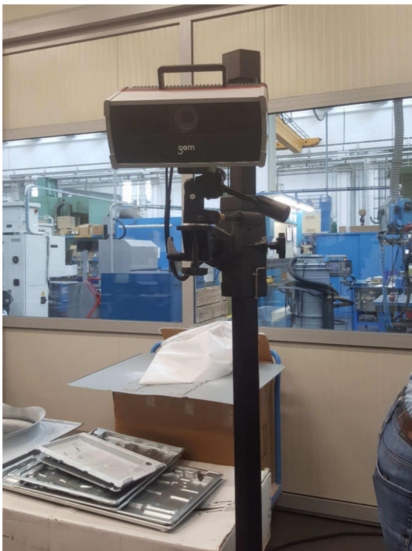
Gom Atos Capsule 8MPx: macchina di misura di precisione (OPMM) per la digitalizzazione superficiale di componenti, acquistata grazie al finanziamento del POR.
