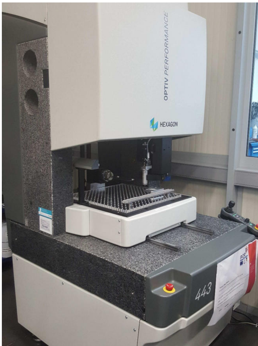
Hexagon Optiv Performance 443: macchina di misura a coordinate multisensore acquistata grazie al finanziamento del POR.
