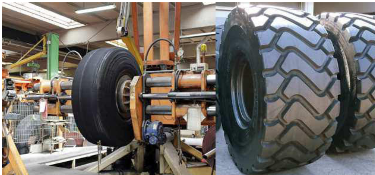
Fasi del processo di ricostruzione dei pneumatici giganti nella Piave Tyres
