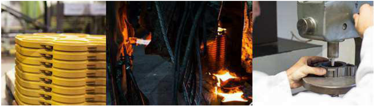
Le fasi di produzione: formatura anime, fusione e finitura.
